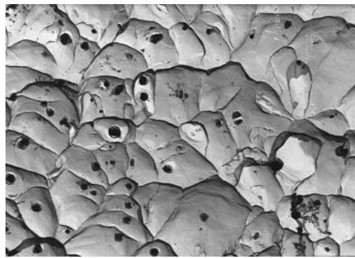
Рис. 1. Вязкое «чашечное» разрушение стали вне зоны дефекта, x3700
