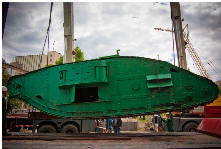
Рис. 5. Рисунок клепочных рядов танка Mk V (Великобритания)
