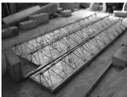
Рис. 1. Вигляд опалубкової залізобетонної плити в бетонному цеху після виготовлення
