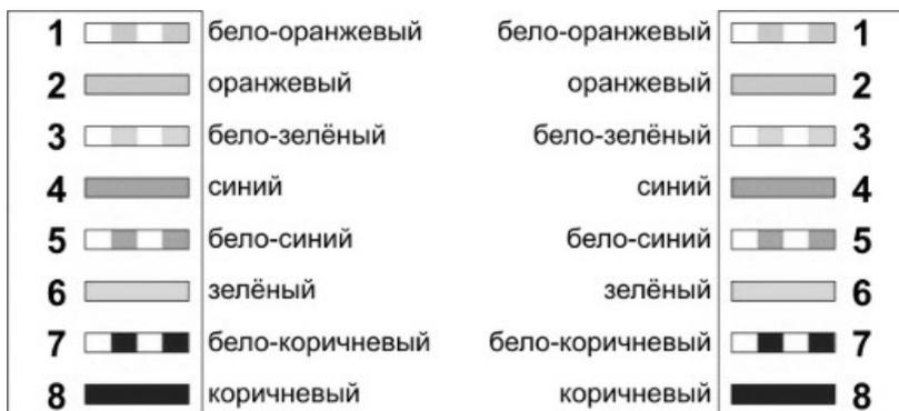
**Рис. 3. Прямой порядок обжима витой пары, ведущей от рабочей станции к концентратору**
